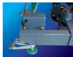
剎車安全裝置 剎車未頂到地，機台不作動
