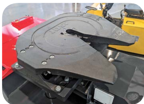
附風管氣壓煞車標準貨櫃板台
